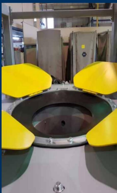
BigBag stroj za praznjenje je zasnovan modularno sistem za odvajanje oz. praznjenje BigBag vreč. Enostavno vstavljanje (FIBC) BigBag vreč v nosilni okvir. Sistem omogoča brez-prašno praznjenje.
