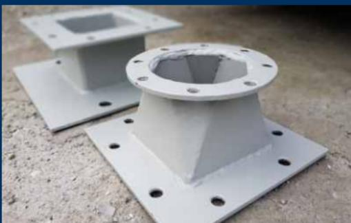
Konstruiranje in izdelava namenskih prirobnic za enostavno montažo na obstoječ sistem
