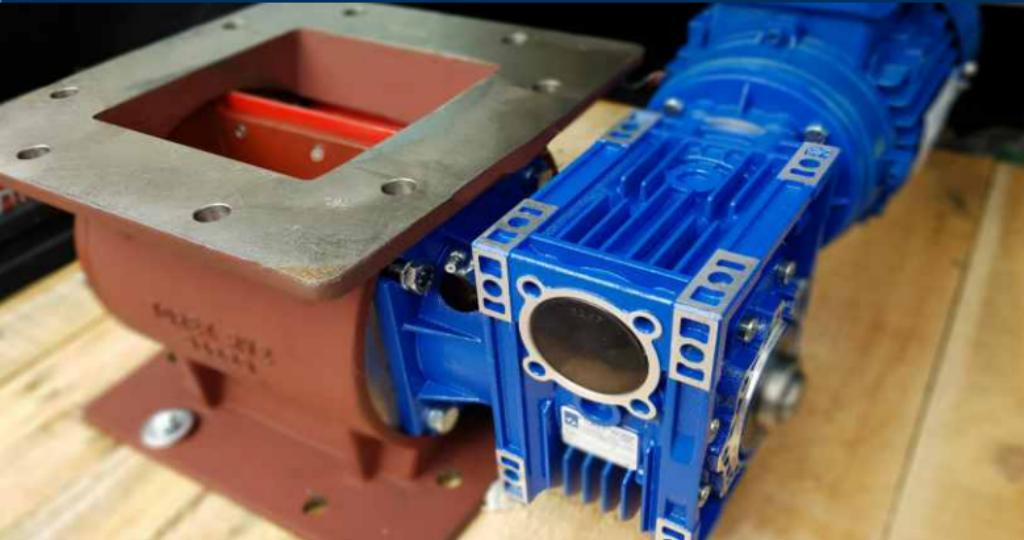
Za namen proizvodnje plastičnih mas, smo izdelali nov sistem doziranja iz silosa s celičnim dozatorjem in namenskim polžnim transportom.
